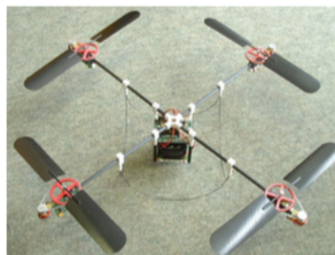
Figura 12 – Micro VTOL construído por Bouabdallah et al. para análise das técnicas de controle PID e linear quadrática (BOUABDALLAH et al. , 2004)
