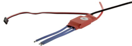
Figura 19 – Ilustração do ESC: "30A SimonK Firmware ESC"
