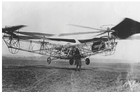
Figura 3 – Quadrirotor projetado para o US Army Air Corps em 1922 (THE VERTICAL MAGAZINE, 2012)
