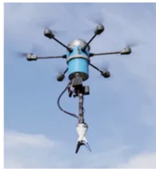
Figura 10 – Quadricópteros desenvolvidos para detectar e detonar minas terrestres (THE VERGE, 2016)
