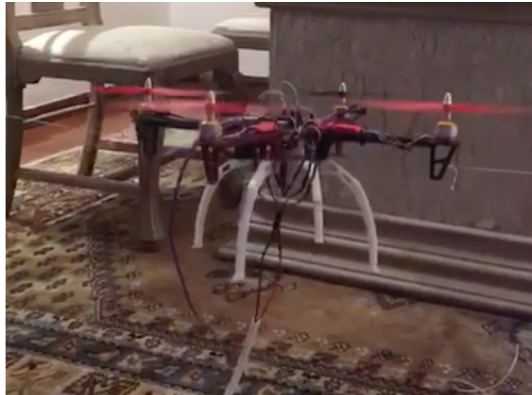
Figura 56 – Estrutura desenvolvida para simulação do movimento de rolagem do quadricóptero
